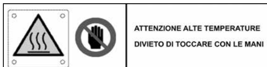
Fig. 2 - Etichette di sicurezza installate sull'apparato
